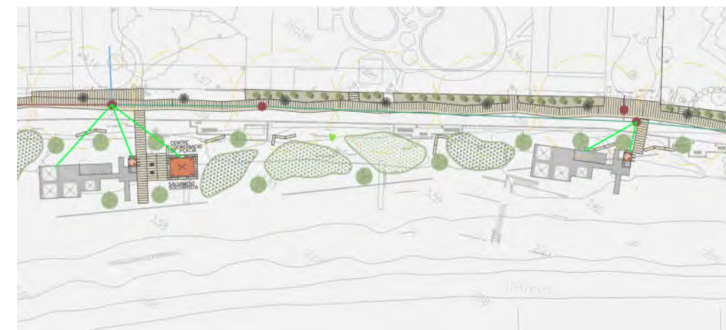
Ilustración 2. Instalación de acometidas de saneamiento.
