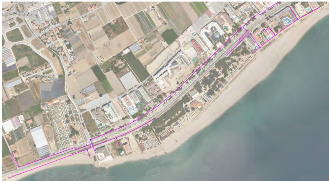
Ilustración 1. Red de agua potable existente.
