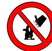
PROHIBIDO APAGAR CON AGUA
