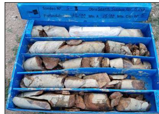
CAIXA N°5. DE 12.00 A 15.00 m. FI DE SONDEIG
