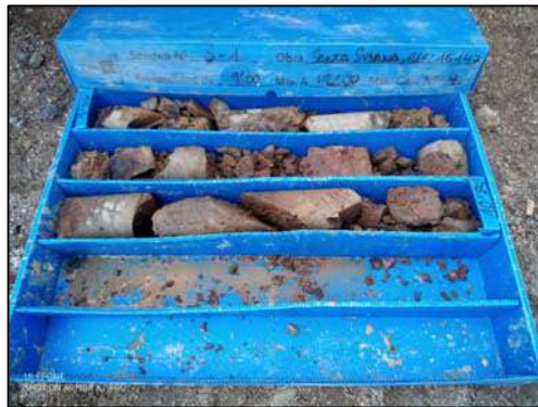
CAIXA N°4. DE 9.00 A 10.80 m. FI DE SONDEIG
