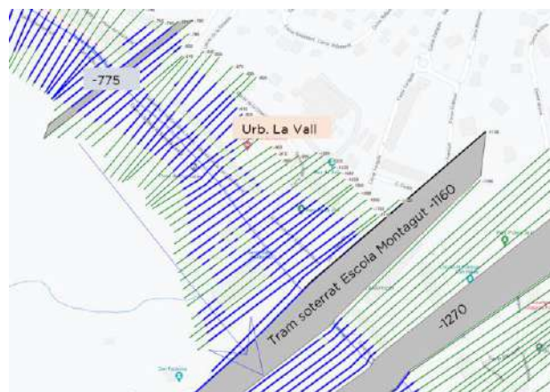
Figura 27. TRAM entre el final de la Rambla del Montnegre i l'Escola Montagut modelitzat per l'ACA 2022. Làmina d'inundació per un Q_{100} .
